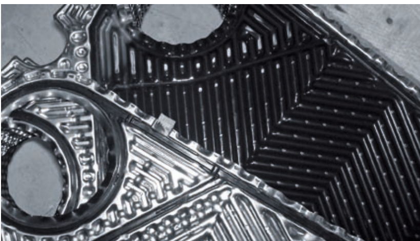
A hőcsere központja: minél tisztábbak a lemezek, a rések és a köztés terek, annál könnyebb a hőcserélőben a közeg áramlása.
